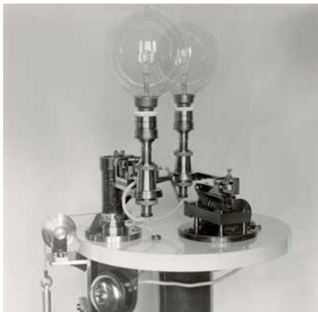
De lampenwisselaar van de buitentoren uit 1921.
